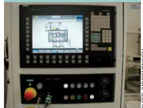
HMI, bestehend aus Sinumerik Bedientafelfront OP 012 und Pushbutton Panel PP 012 von Siemens
