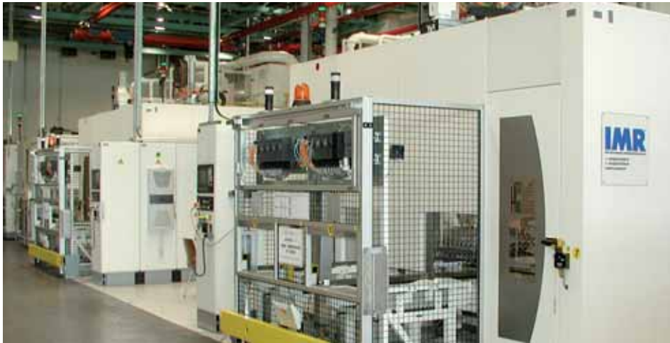
Außenansicht der IMR Be-/Entladezelle für Härteroste mit Zu- und Auslaufpuren für die Gusseisenhärteroste
